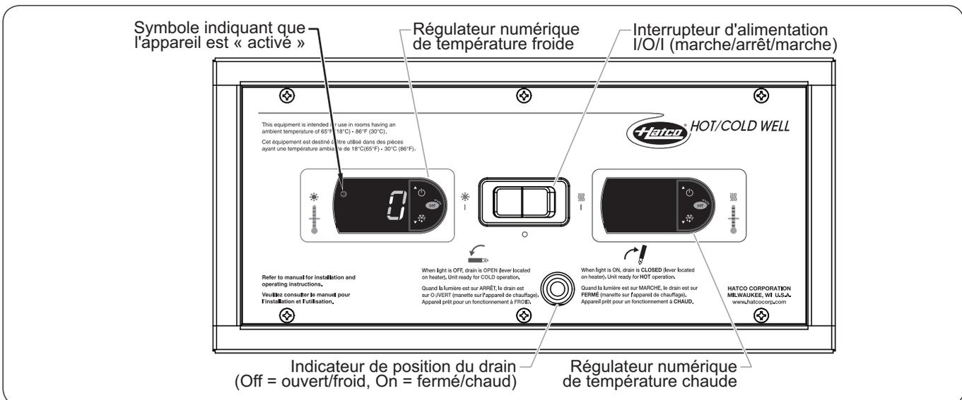
Boîtier de commande série HCWBI (vue de l'utilisation en mode FROID)
