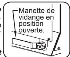
*NOTA: La manette d'évacuation doit être en position ouverte pour l'utilisation de l'appareil en mode FROID.*
