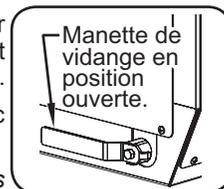
4. Reliez le tuyau de rinçage équipé d'un adaptateur à une arrivée d'eau froide et placez le tuyau sur la crépine de sortie. Projetez l'eau fraîche dans l'appareil jusqu'à ce que l'eau déversée par le tuyau de vidange soit propre.
