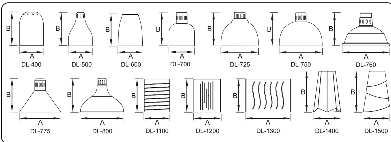
NOTA: La hauteur de l'abat-jour augmente de 2" (51 mm) lorsque l'interrupteur inférieur (configuration L) est choisi.
